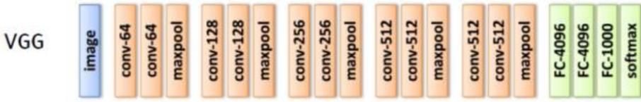
图 6.56: VGG 网络结构图
